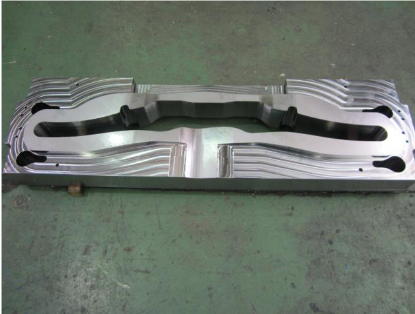
Fig 1. Prensa parte de matriz progresiva hecha en Toolox 44
