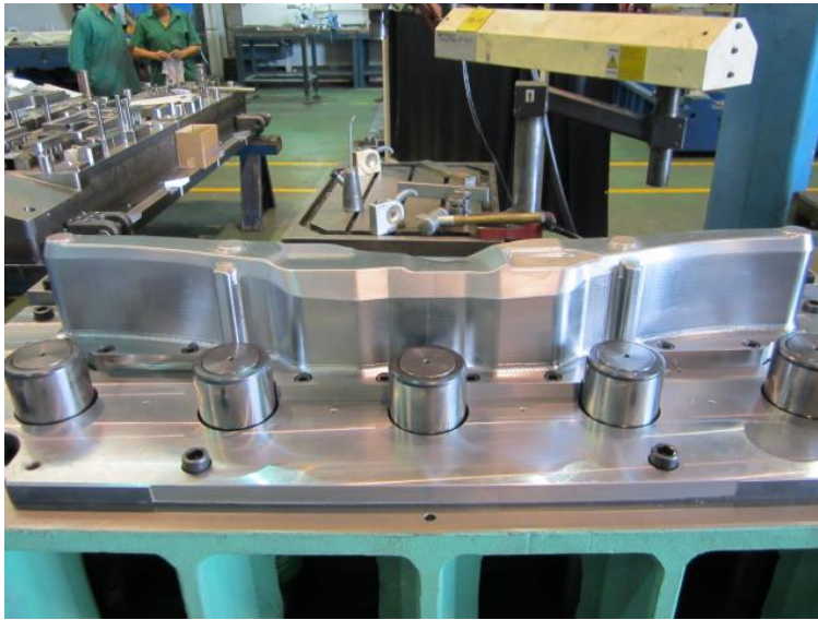
Fig. 2. Segunda pieza Toolox 44 para conformado en frío progresivo
